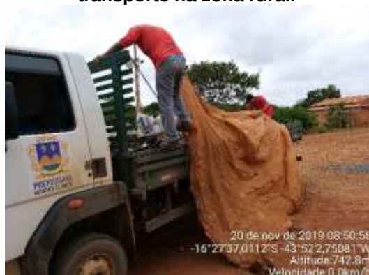
Figura 100 - Cobertura da carroceria do caminhão de coleta, de forma a evitar o espalhamento de resíduos durante o transporte na zona rural.
