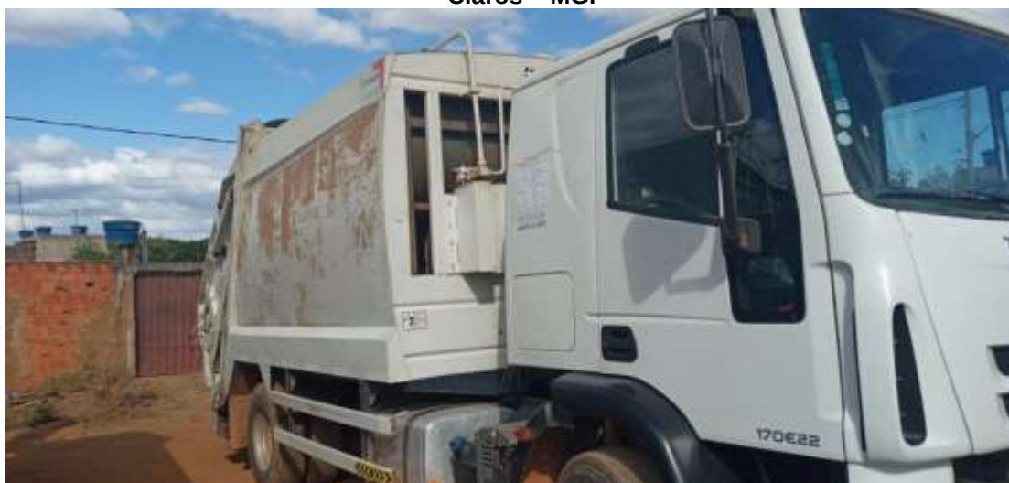
Figura 74 – Exemplo do modelo de veículo utilizado para a coleta dos RSU em Montes Claros – MG.
