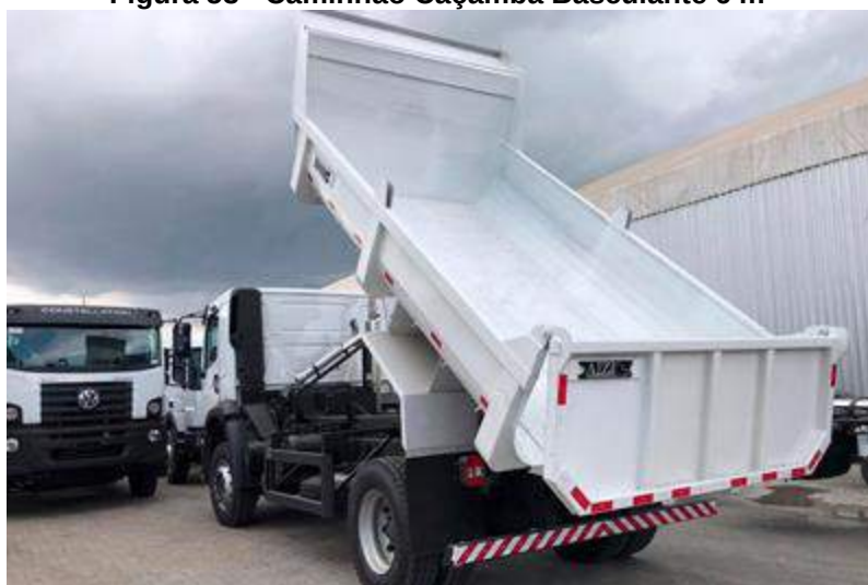
Figura 53 - Caminhão Caçamba Basculante 6 m 3
