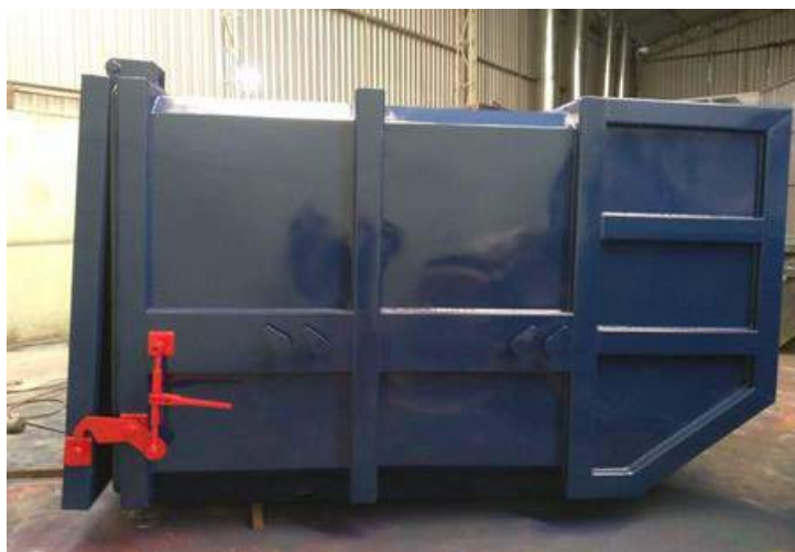
Figura 50 - Compactador estacionário 7 m 3
