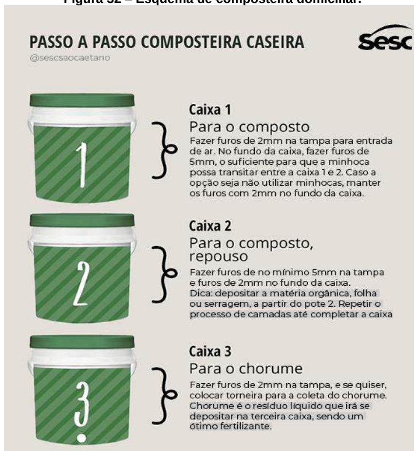
Figura 32 – Esquema de composteira domiciliar.
