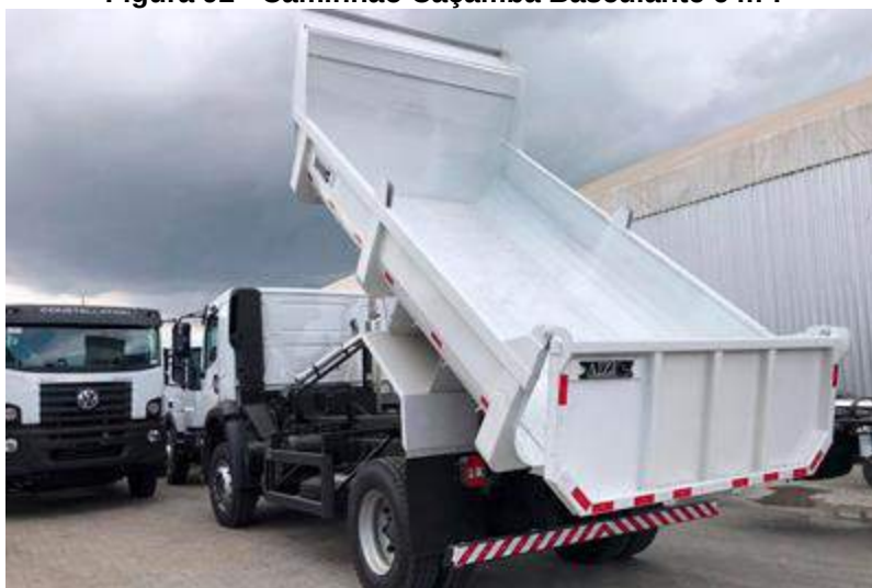
Figura 92 - Caminhão Caçamba Basculante 6 m 3 .
