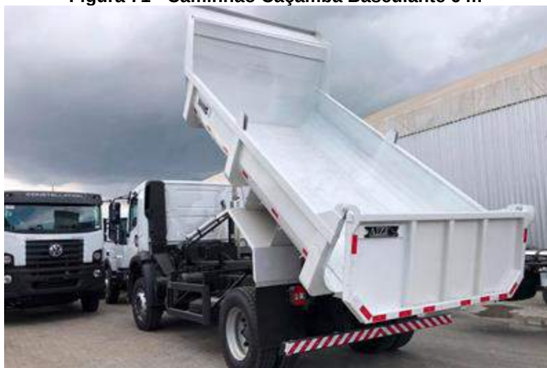
Figura 71 - Caminhão Caçamba Basculante 6 m 3
