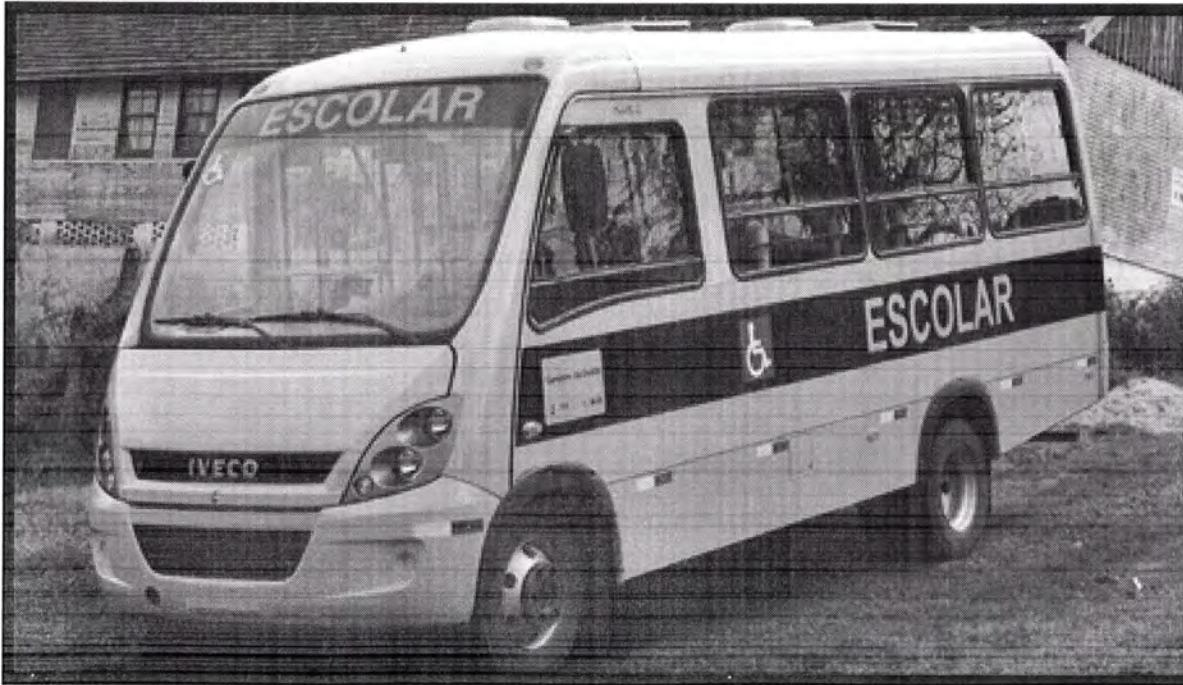
Ônibus rural escolar com comprimento total máximo de 7.000mm, capacidade de carga útil líquida de no mínimo 2.000kg, e podendo ser equipado com plataforma elevatória veicular.
